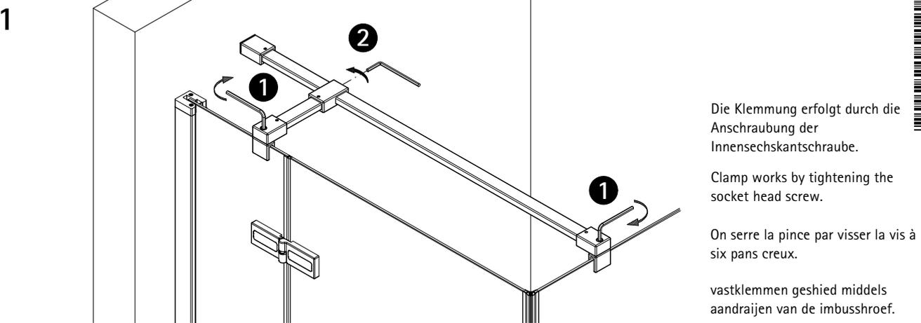
Die Klemmung erfolgt durch die Anschraubung der Innensechskantschraube.
